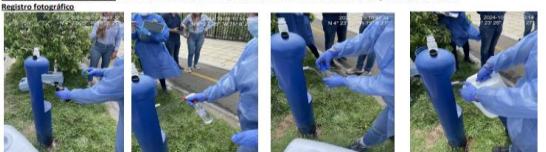
Foto 12. Toma de muestra (Juguetina) Foto 13. Desinfección del punto Foto 14. Toma de muestra microbiológica Foto 15. Toma de muestra para Detección de Giardia y Cryptosporidium
